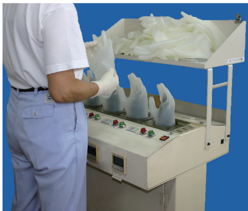
「ダイローブ20」のピンホール検査風景 (工場内)
