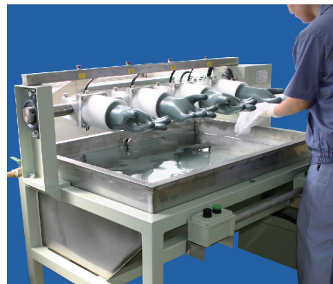
「ダイローブA95」のピンホール検査風景 (工場内)
